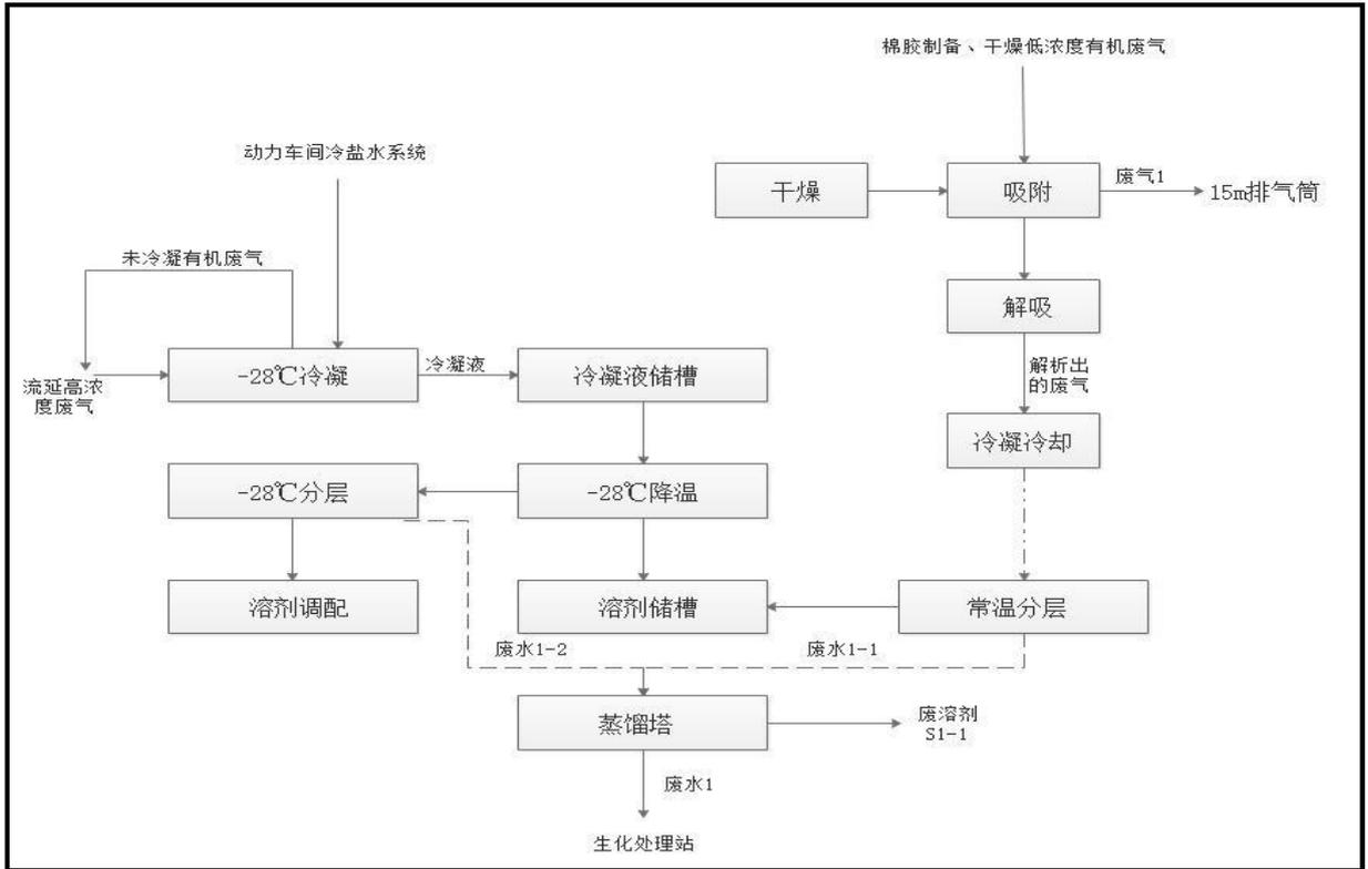
图 4-44 片基一部溶剂冷凝回收系统
