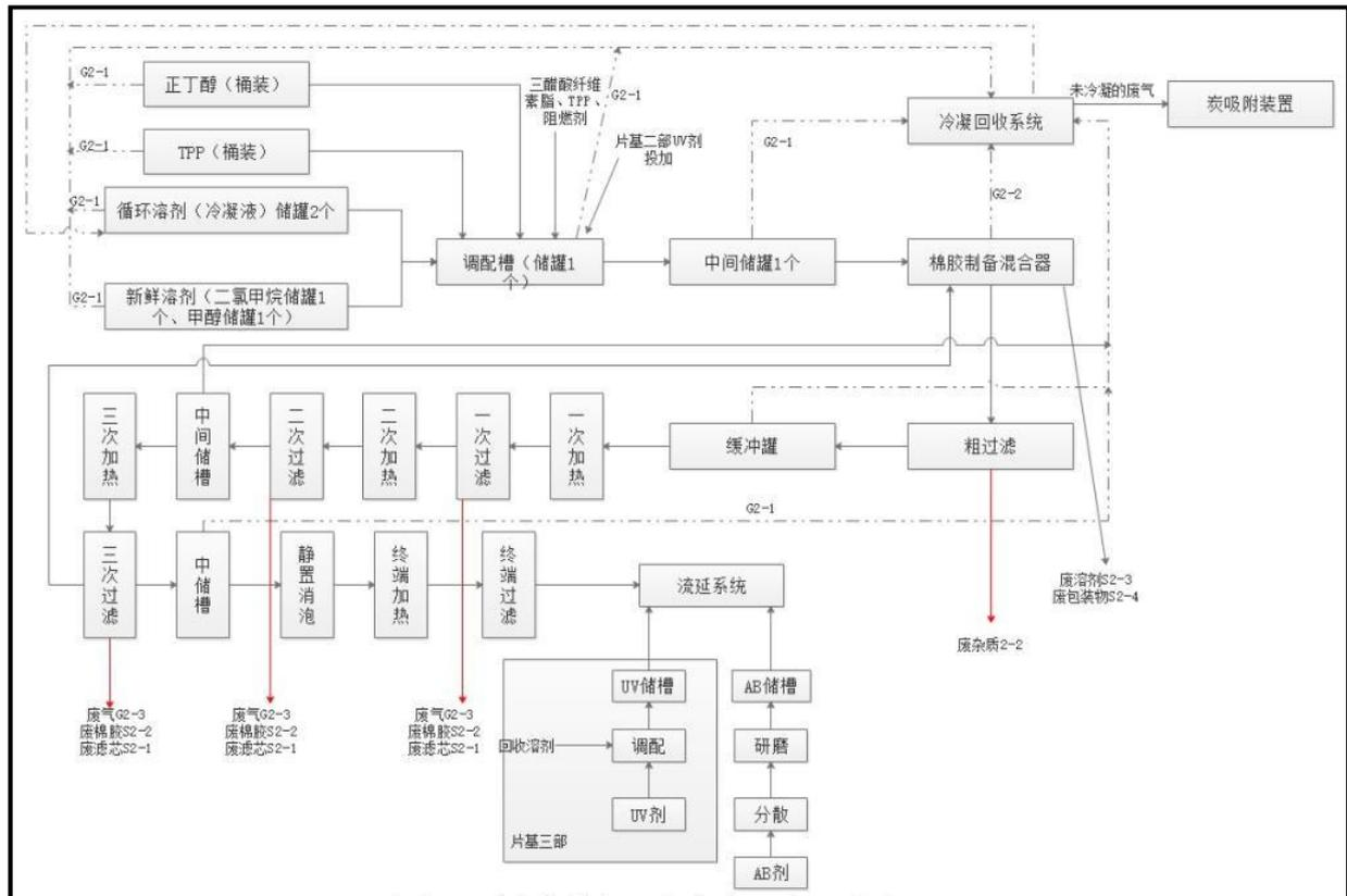
图 4-46 棉胶制备工艺流程图
