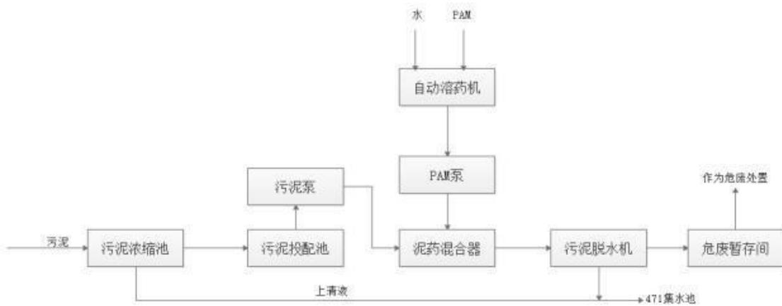
图 4-58 污泥脱水处理流程示意图
