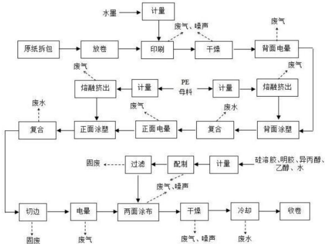
图 4-10 涂塑纸基生产工艺流程图
