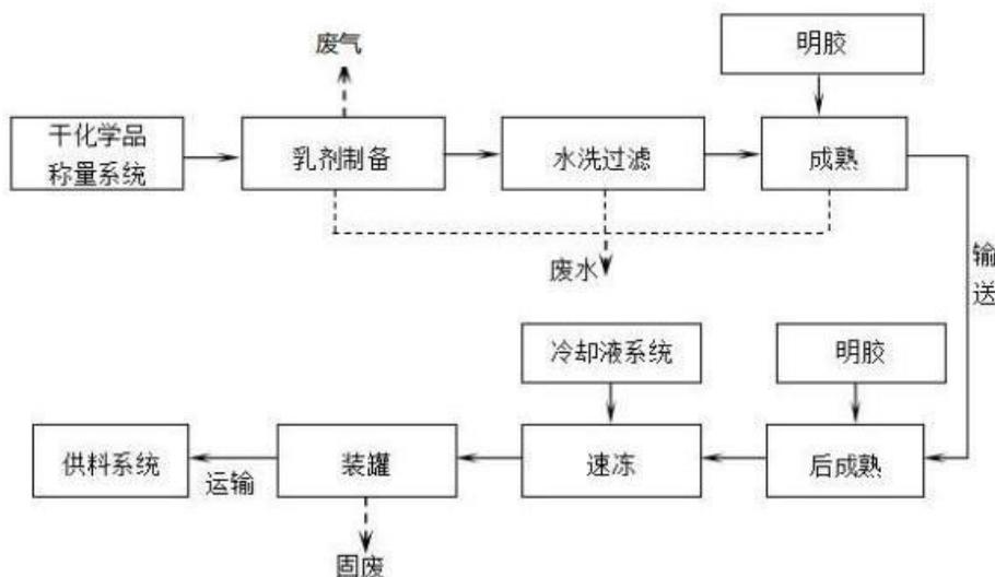
图 4-3 乳剂生产工艺流程图
