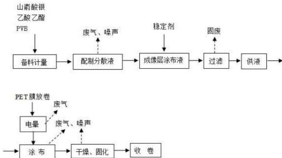
图 4-13 A 型片生产工艺流程图
