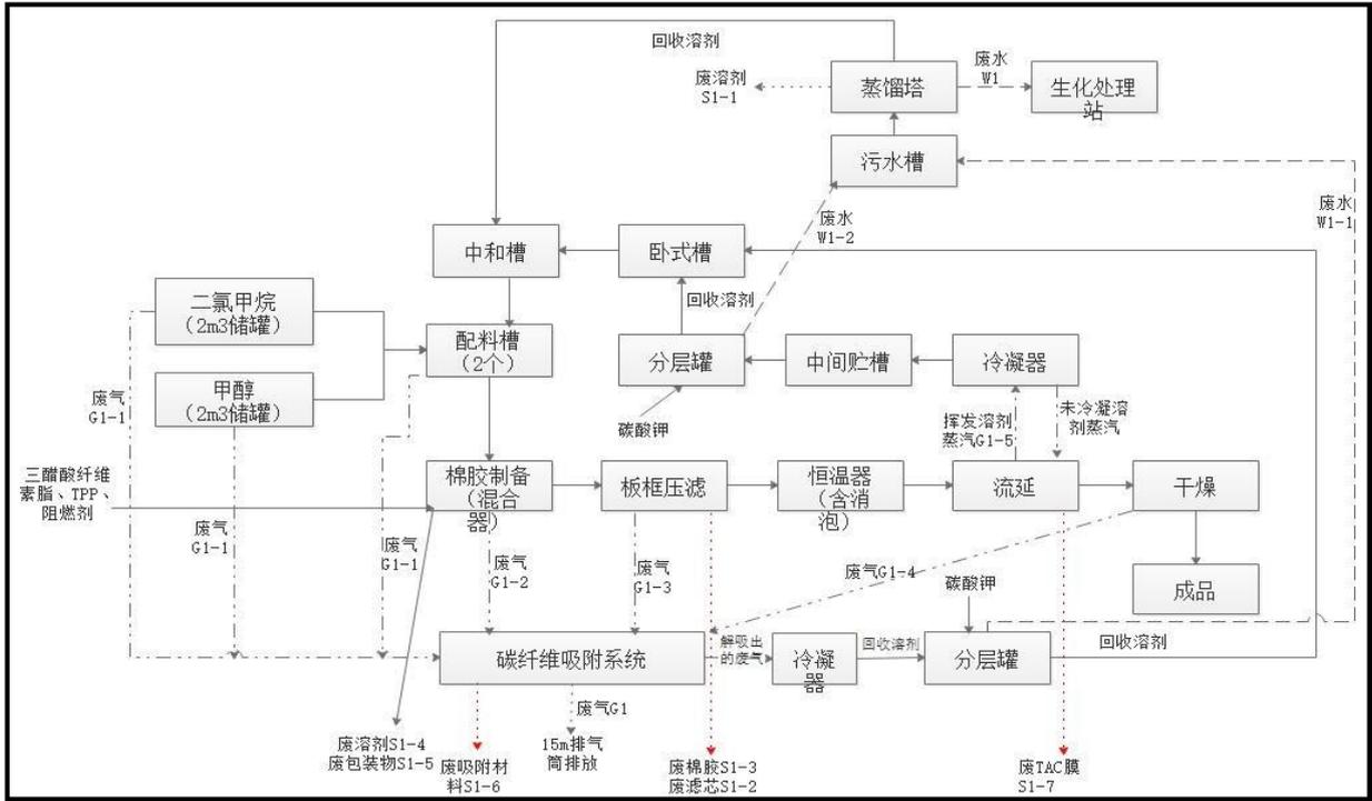
图 4-43 片基一部工艺流程示意图
