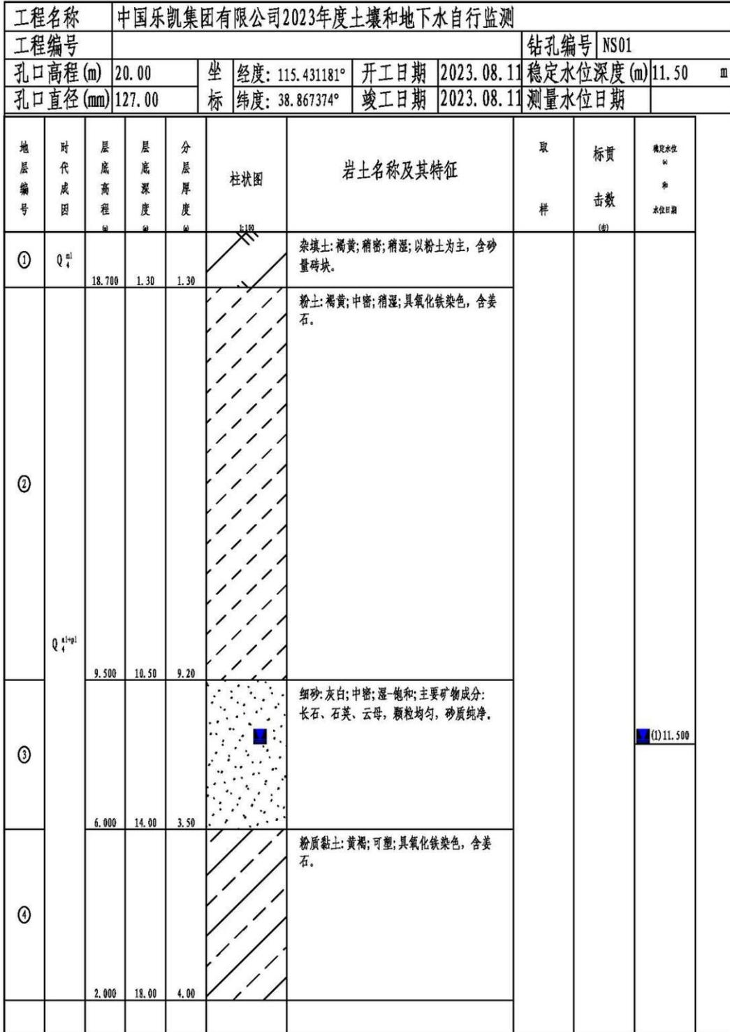
图 3-1 2023 年土壤自行监测实际钻探成果柱状图 (NS01)
