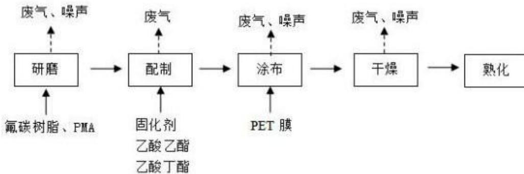
图 4-16 实验 2 生产工艺流程图
