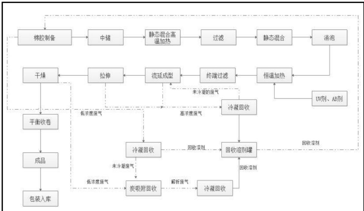
图 4-45 片基二部、片基三部整体工艺流程图
