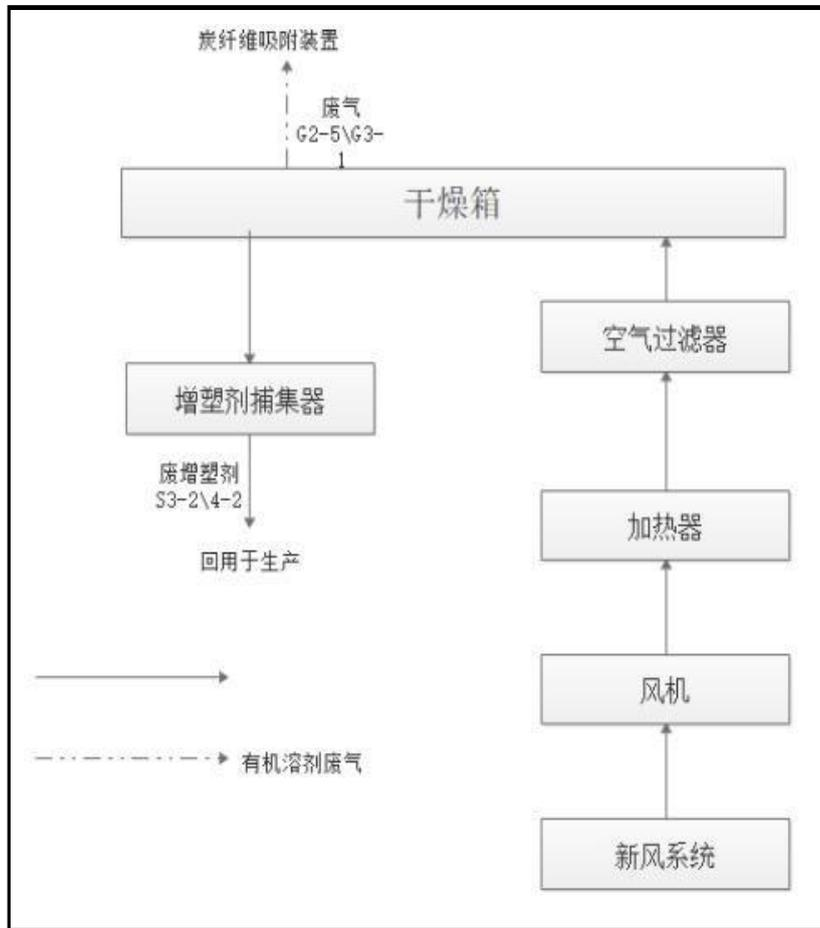
图 4-50 干燥工艺流程示意图
