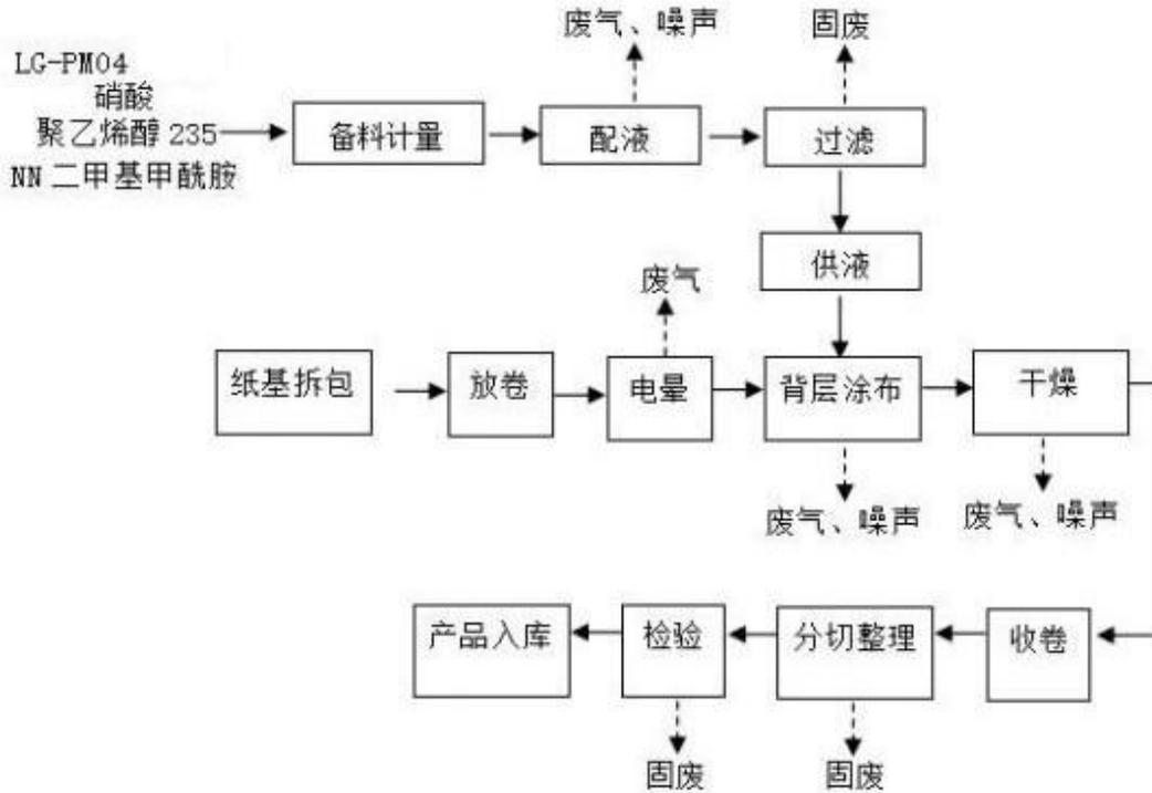
图 4-8 喷墨打印纸生产工艺流程图
