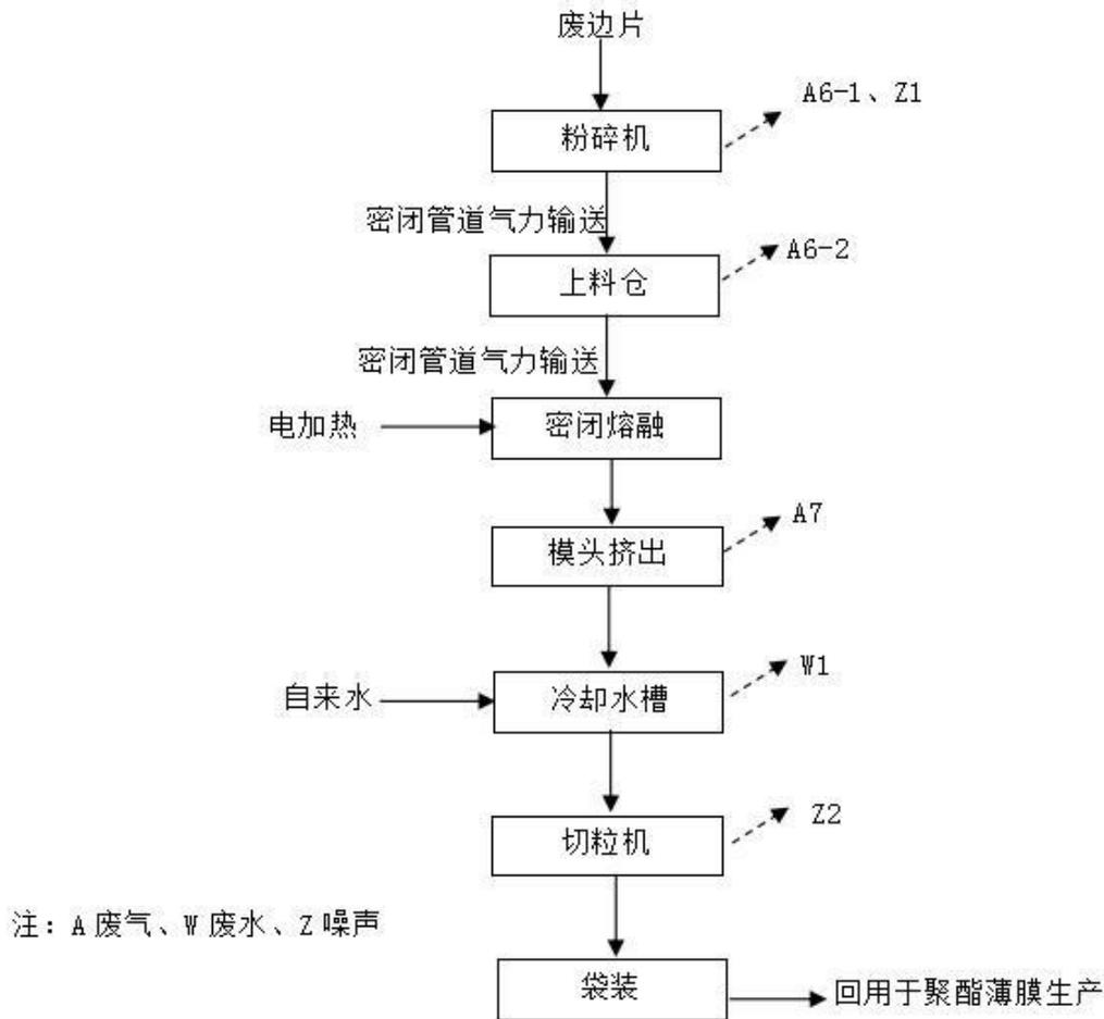
图 4-40 基材车间废边片再生造粒生产工艺流程及排污节点图
