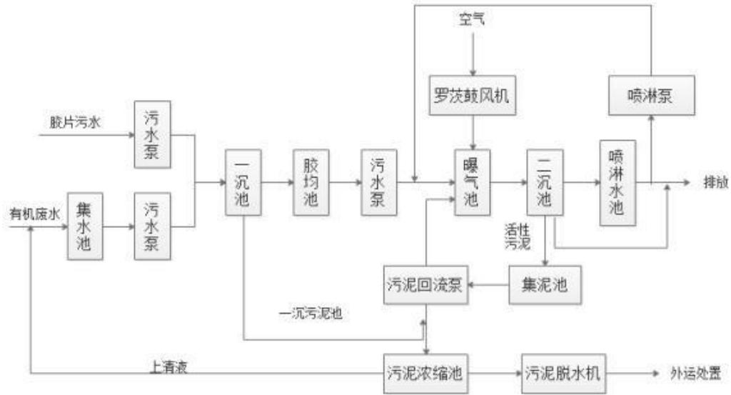
图 4-57 生化处理厂工艺流程图及产污节点
