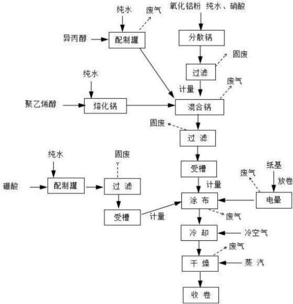
图 4-6 喷墨打印纸生产工艺流程图
