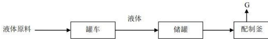
图 4-20 EDTA 铁铵盐储罐区原料输送示意图（EDTA 铁铵盐不挥发、无味）
