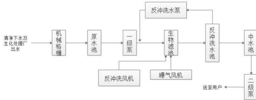
图4-60 中水处理站工艺流程图及产污节点
