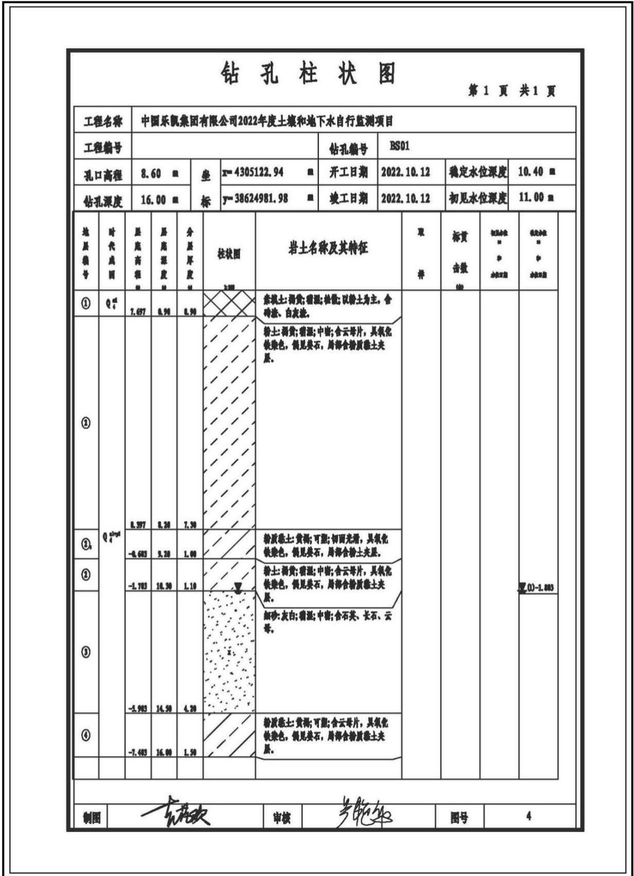
图 3-2 2022 年土壤自行监测实际钻探成果柱状图 (BS01)
