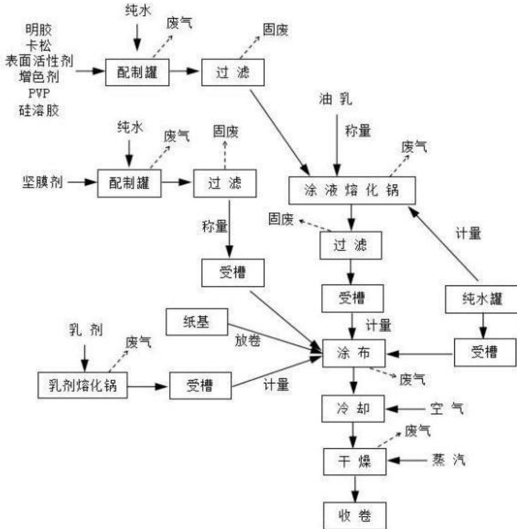
图 4-5 彩色相纸生产工艺流程图
