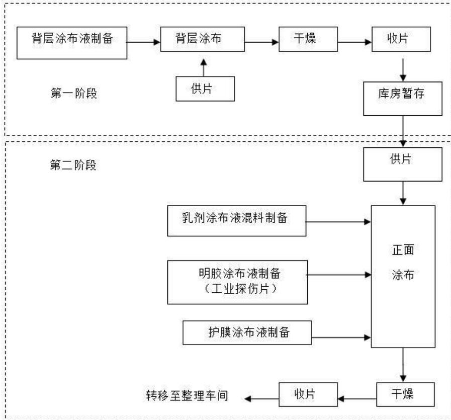
图 4-26 涂布车间生产总体工艺流程图
