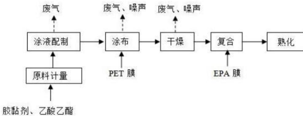
图 4-15 实验1 生产工艺流程图
