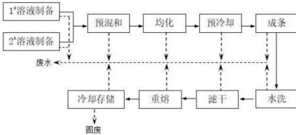
图 4-4 油乳生产工艺流程图
