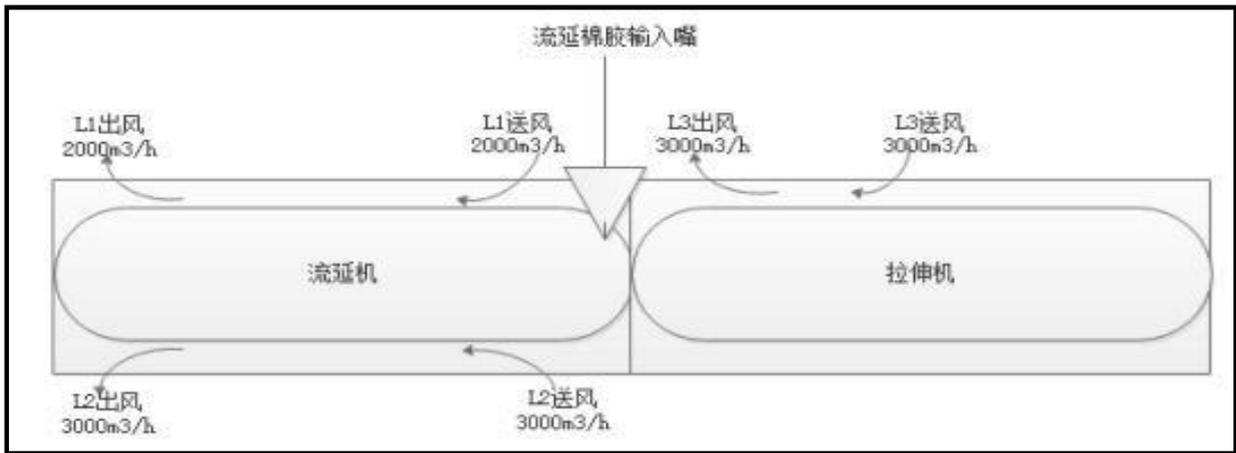
图 4-48 流延拉伸通风系统现状示意图
