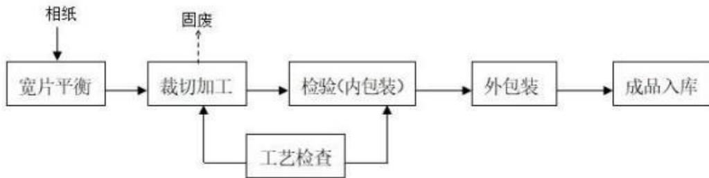
图 4-7 彩色相纸整理工艺流程图
