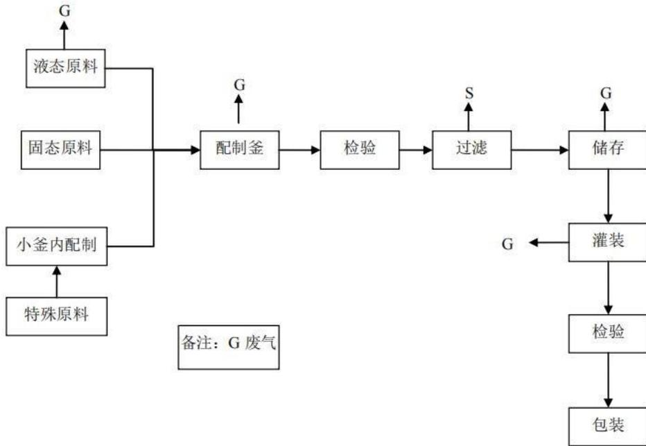
图 4-18 套药生产总工艺流程图
