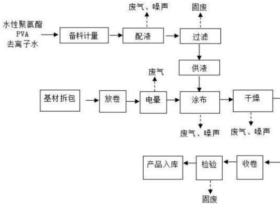
图 4-9 医疗干式片生产工艺流程图
