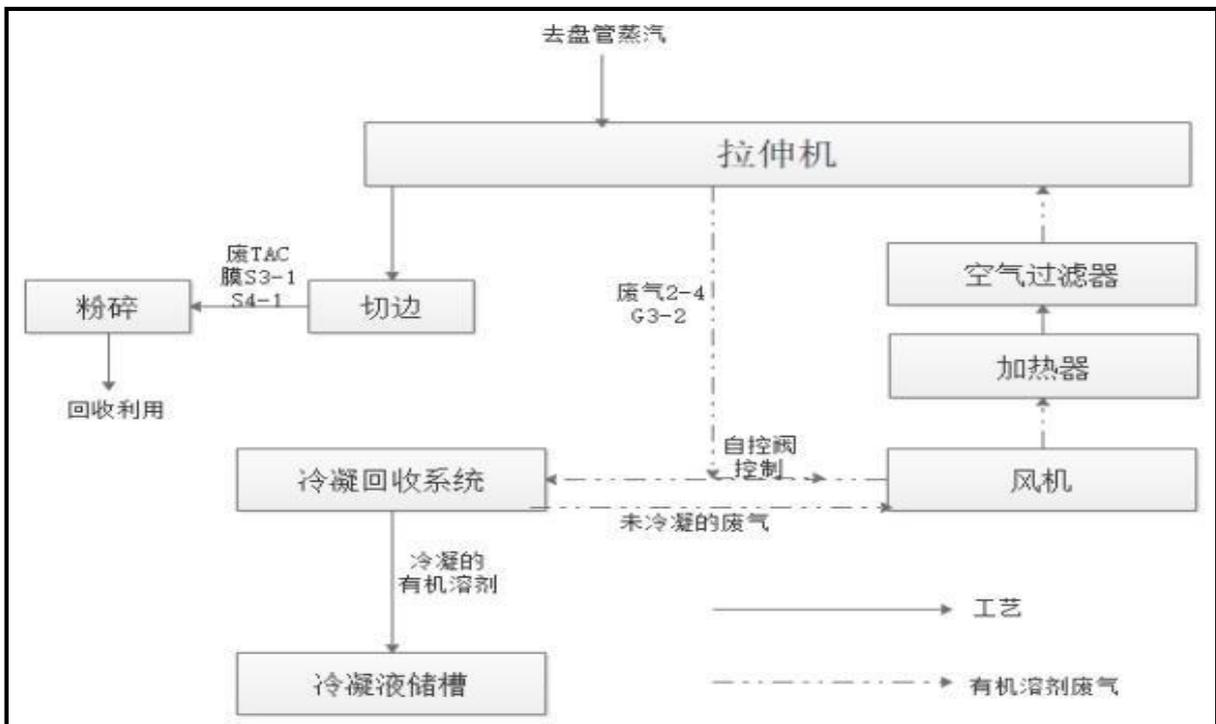
图 4-49 拉伸工艺流程示意图
