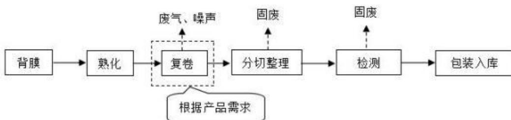
图 4-14 太阳能背膜整理工艺流程图
